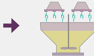
**3** Se añade el tensoactivo, ya que otros aditivos, en particular los que afectan la viscosidad, pueden dificultar la disolución del tensoactivo.
