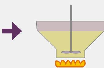
**2** Se dosifica agua en el recipiente de proceso, a menudo se calienta alrededor de 55°C a 60°C para ayudar a la disolución e hidratación de otros ingredientes.
