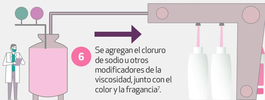
**6** Se agregan el cloruro de sodio u otros modificadores de la viscosidad, junto con el color y la fragancia<sup>7</sup>.
